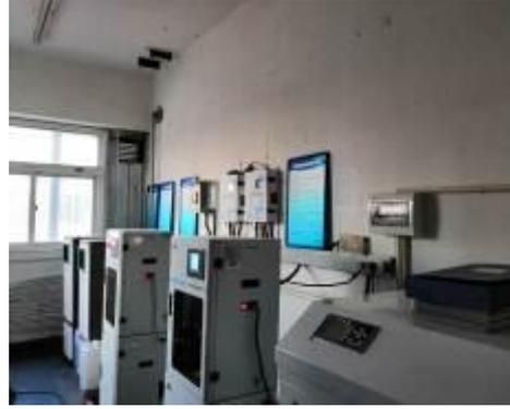
pH、流量、COD、氨氮、总氮、总磷在线监测装置（诺博公司总排口）
